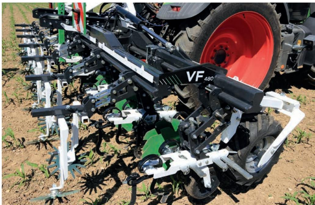
durch ein spezielles Verschlusssystem möglich. Beim fünfscharigen Modul löst ein Exzenter-Spannhebel die beiden äußeren Balken, beim dreischarigen Modul muss dafür (nur) eine Schraube gelockert werden. Die Zinkenbalken sind mit Rasten versehen. So ist das schnelle Wiederfinden der gewünschten Position möglich.
