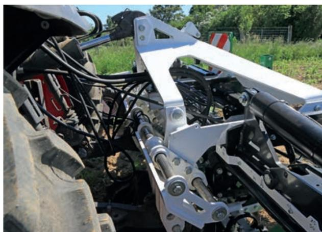
Der Anbaubock kann für Front- und Heckanbau gedreht werden. Darunter sitzt der kompakte Verschieberahmen.
